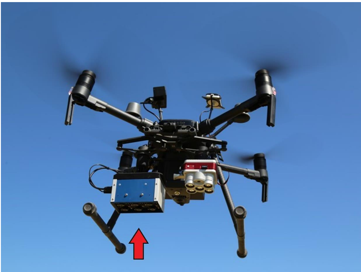
Abbildung 3: Drohne mit unterschiedlichen Kameras. Der rote Pfeil weist auf die Multispektralkamera hin.
